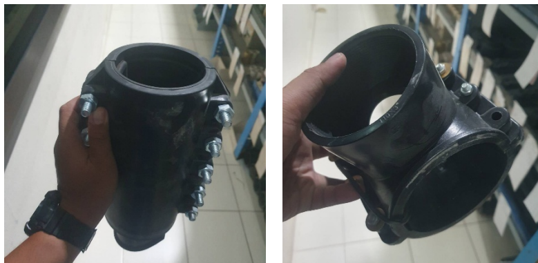
รูปที่ 2-29 อุปกรณ์ที่ใช้สำหรับอุดรอยรั่ว
